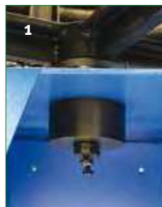
▲ РОЛИКОВАЯ КАТУШКА С МЕХАНИЧЕСКИМ ТОРМОЗОМ
