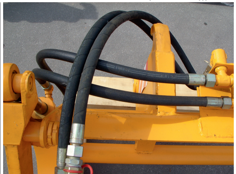
На данном рисунке рукав опрессован правильно, протечек масла и вздутий нет
